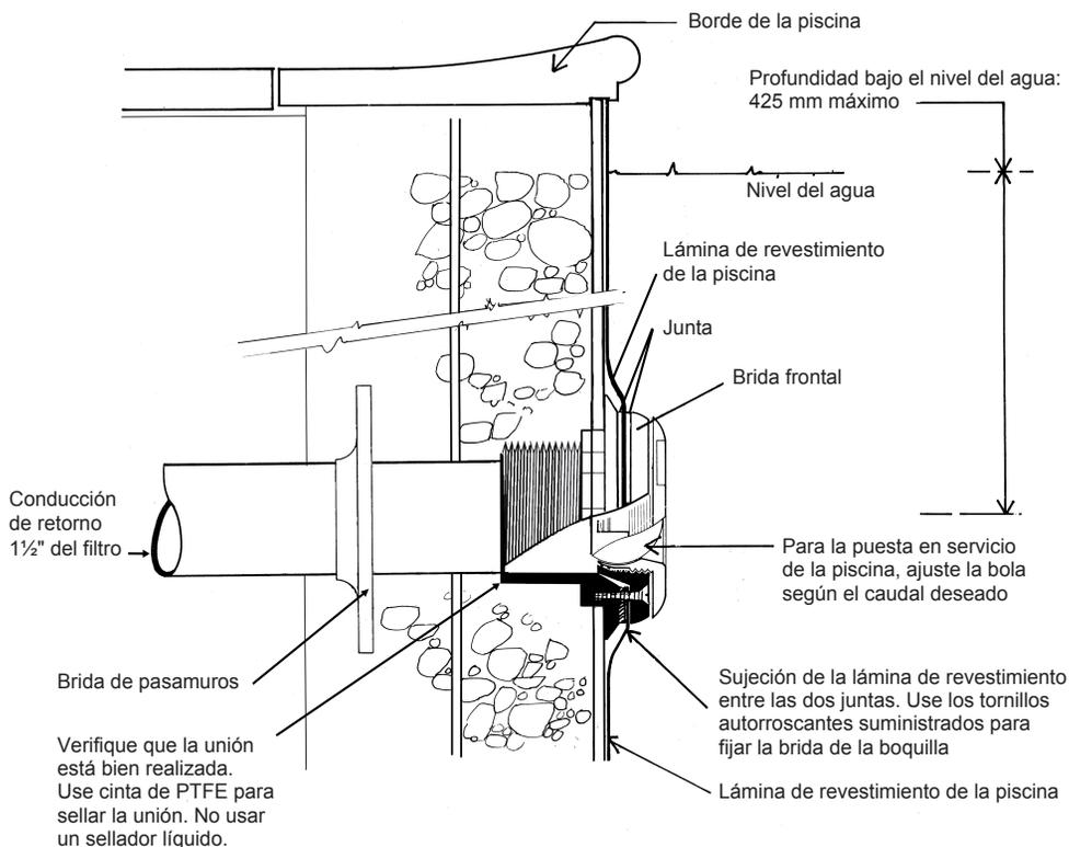
**IMPORTANTE:** Debe realizarse el ensayo de estanqueidad de las conducciones y los accesorios de la piscina antes de proceder al relleno y a la puesta en servicio
