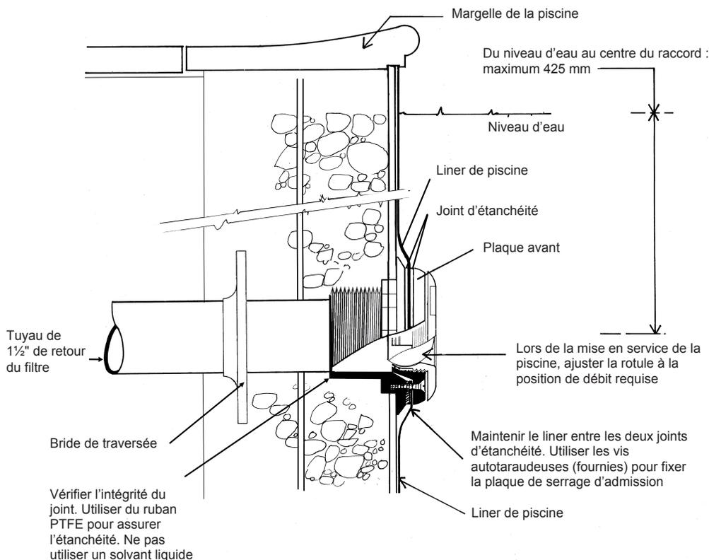
**IMPORTANT : tous les tuyaux et raccords de la piscine doivent faire l'objet d'un essai de pression avant le remblayage et la mise en service**
