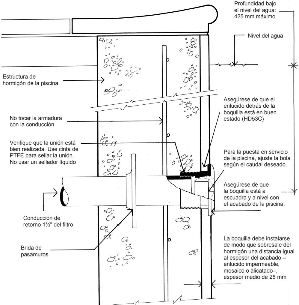
**IMPORTANTE:** Debe realizarse el ensayo de estanqueidad de las conducciones y los accesorios de la piscina antes de proceder al relleno y a la puesta en servicio
