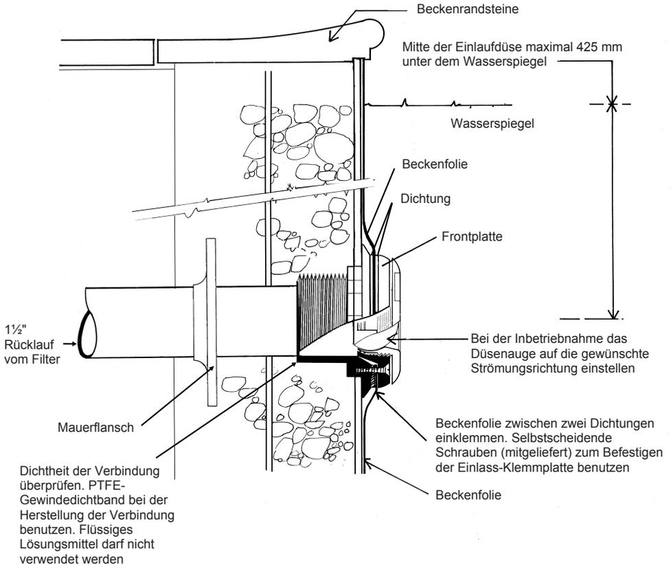
**WICHTIG: die gesamte Verrohrung und alle Beckenanschlüsse müssen vor Hinterfüllen und Inbetriebnahme druckgeprüft werden**
