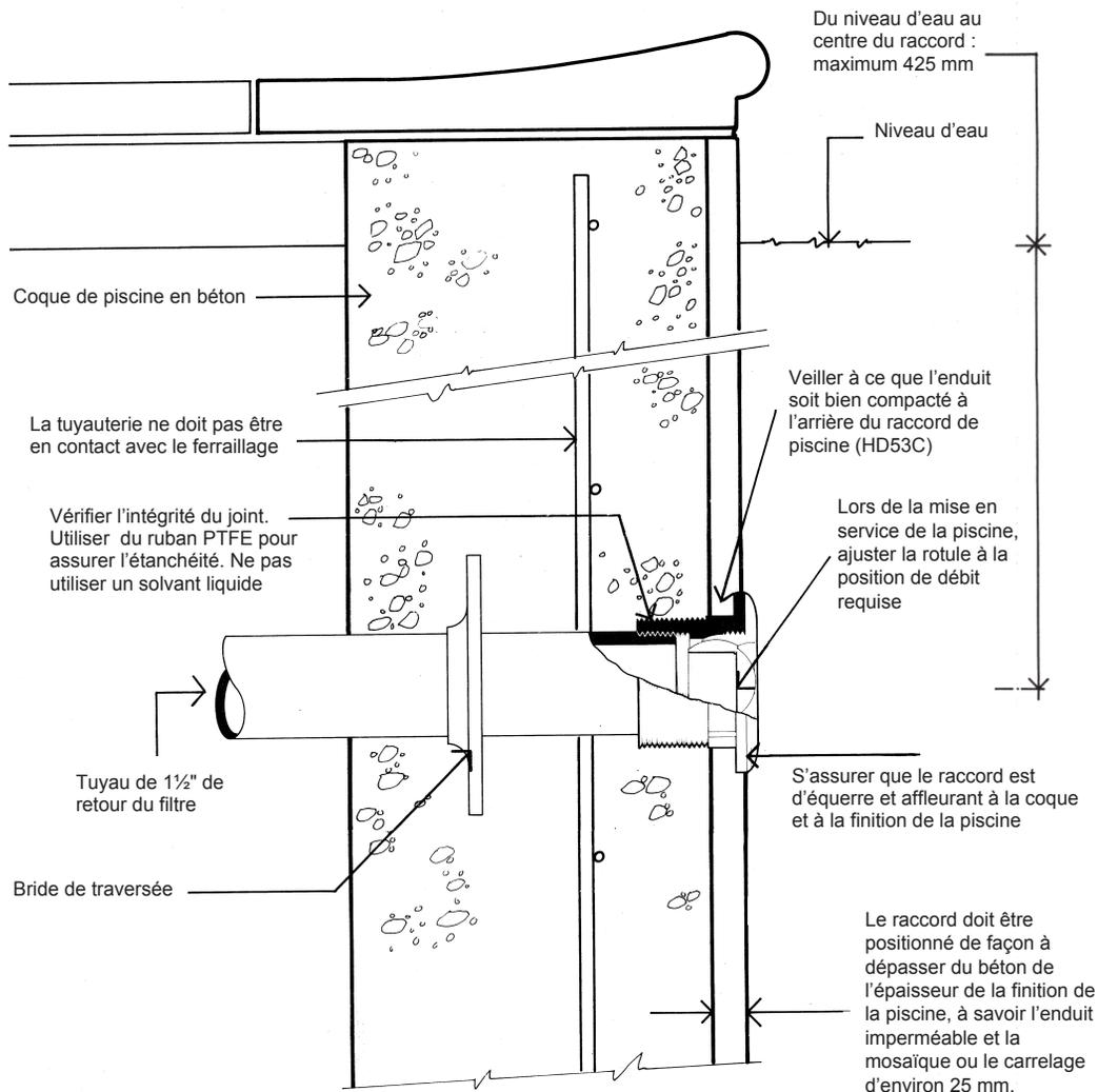
**IMPORTANT : tous les tuyaux et raccords de la piscine doivent faire l'objet d'un essai de pression avant le remblayage et la mise en service**
