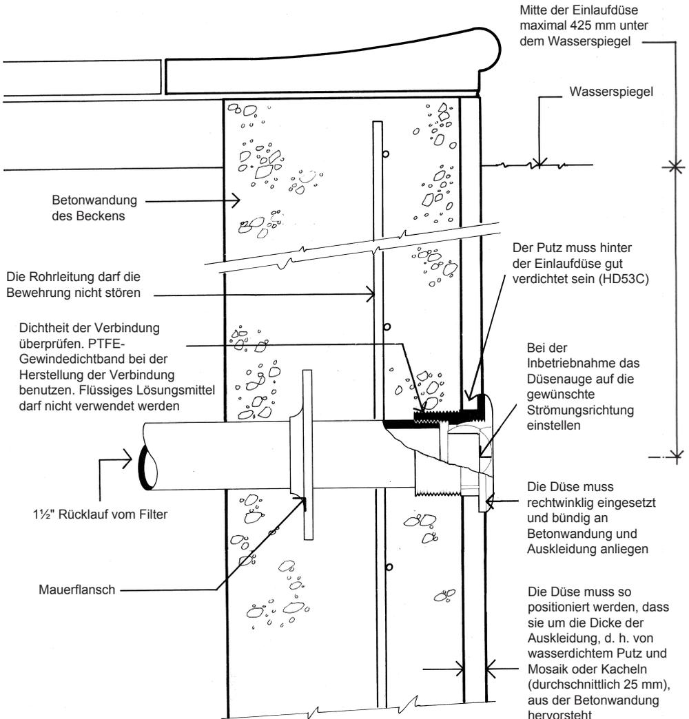
**WICHTIG: die gesamte Verrohrung und alle Beckenanschlüsse müssen vor Hinterfüllen und Inbetriebnahme druckgeprüft werden**
