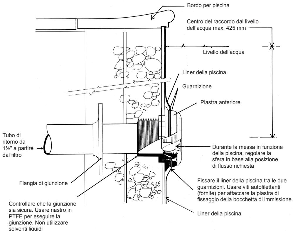
**IMPORTANTE: tutte le tubature e i raccordi della piscina devono essere sottoposti alla prova di resistenza alla pressione prima di completare i lavori con materiale di riempimento e della messa in funzione**
