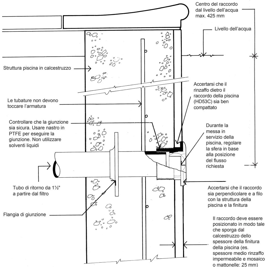
**IMPORTANTE: tutte le tubature e i raccordi della piscina devono essere sottoposti alla prova di resistenza alla pressione prima di completare i lavori con materiale di riempimento e della messa in funzione**
