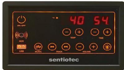
Appuyez sur **Marche/Arrêt** pour mettre la commande en marche. Les éléments chauffants commencent à chauffer. La température de la cabine et la durée de fonctionnement s'affichent. La durée de fonctionnement est automatiquement activée à 60 minutes ou à la dernière durée sélectionnée. Si vous appuyez à nouveau sur **Marche/Arrêt**, toutes les fonctions (éléments de chauffage, lumière et musique) se désactivent.
