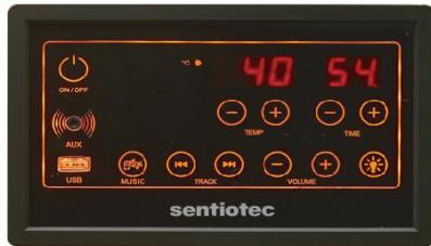
Käynnistää ohjain painamalla **pääälle/pois**-symbolia. Lämmitysvastukset aloittavat lämmityksen. Saunan lämpötila ja lämmityksen toiminta-aika ovat näytössä. Lämmitysen toiminta-aika on automaattisesti 60 minuuttia tai viimeksi valitun toiminta-ajan mukainen. Mikäli painat uudelleen **pääälle/pois**-symbolia, kaikki toiminnot (lämmityselementit, valaistus ja musiikki) kytkeytyvät pois päältä.
