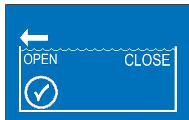
De "OPEN" -positie wordt geprogrammeerd door de ⇲ in te drukken. Houd de pijltoets ⇲ ingedrukt totdat het Roldeck volledig geopend is. De pijl boven de positie "open" knippert. Het type aandrijfmotor wordt automatisch herkend.
