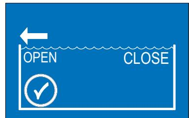
Die Position “OPEN” wird durch Drücken der Pfeiltaste ⇛ gedrückt halten, bis das Roldeck ganz geöffnet ist. Der Pfeil über der Position “Open” blinkt. Der Typ des Antriebsmotor wird automatisch erkannt. Dies wird mit dem Häkchen “✓” angezeigt.
