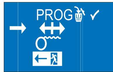
Zum Öffnen der Feineinstellung kurz auf die mittlere Taste mit dem Lampensymbol drücken. ( $\Leftarrow\Rightarrow$  blinkt). Das Roldeck befindet sich der Position „CLOSE“. Dies zeigt an, dass eine Feineinstellung der Position „CLOSE“ möglich ist.
