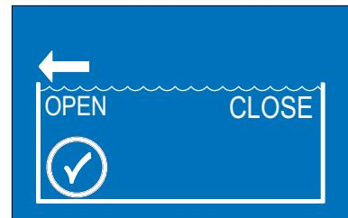
La position "OPEN" est programmée en enfonçant la touche fléchée ⇲. Tenez la touche fléchée ⇲ enfoncée jusqu'à ce que le Roldeck soit totalement ouvert. La flèche au-dessus de la position "open" clignote. Le type de moteur d'entraînement est automatiquement reconnu. Cela est indiqué dans l'affichage par le symbole "✓".
